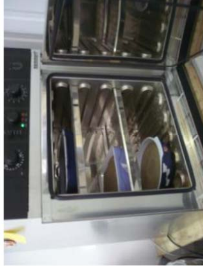
Analyse granulométrique : séchage des sédiments à l'étuve et tamisage sur colonne
