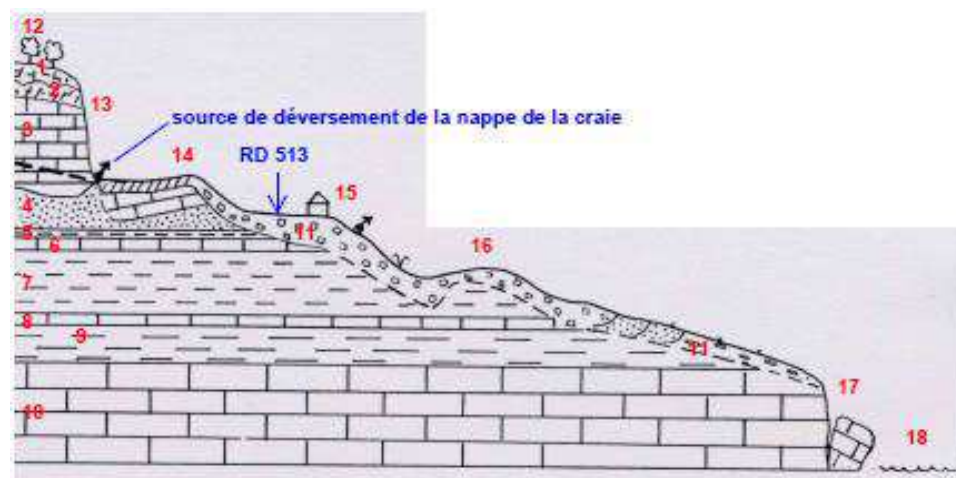
Figure n°2 : coupe géologique schématique du versant côtier à Hennequeville (source : LRPC de Rouen).
