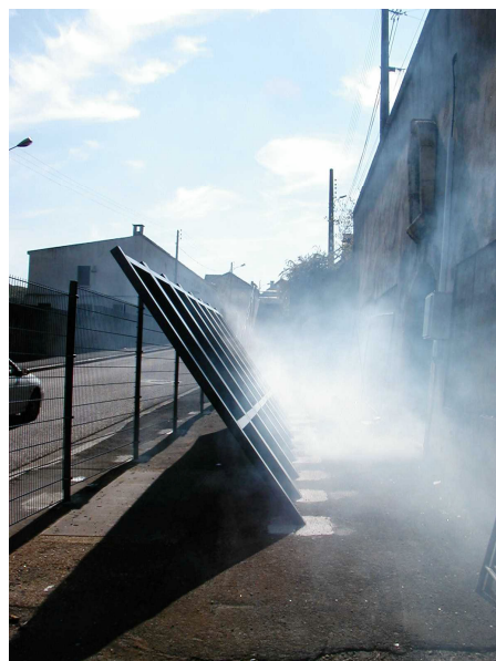
Photo 12 : Visualisation, à l'aide de fumigène, de la sortie de gaz de mine par une galerie minière
