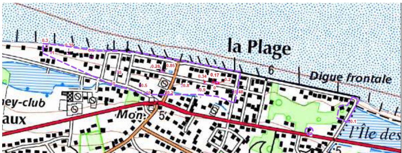
Figure III.47: Relevés des profondeurs d'eau par la submersion marine lors de Xynthia (février 2010) à la Plage et au Paisty Vert à Ver-sur-Mer (source : DDTM de Bayeux).
