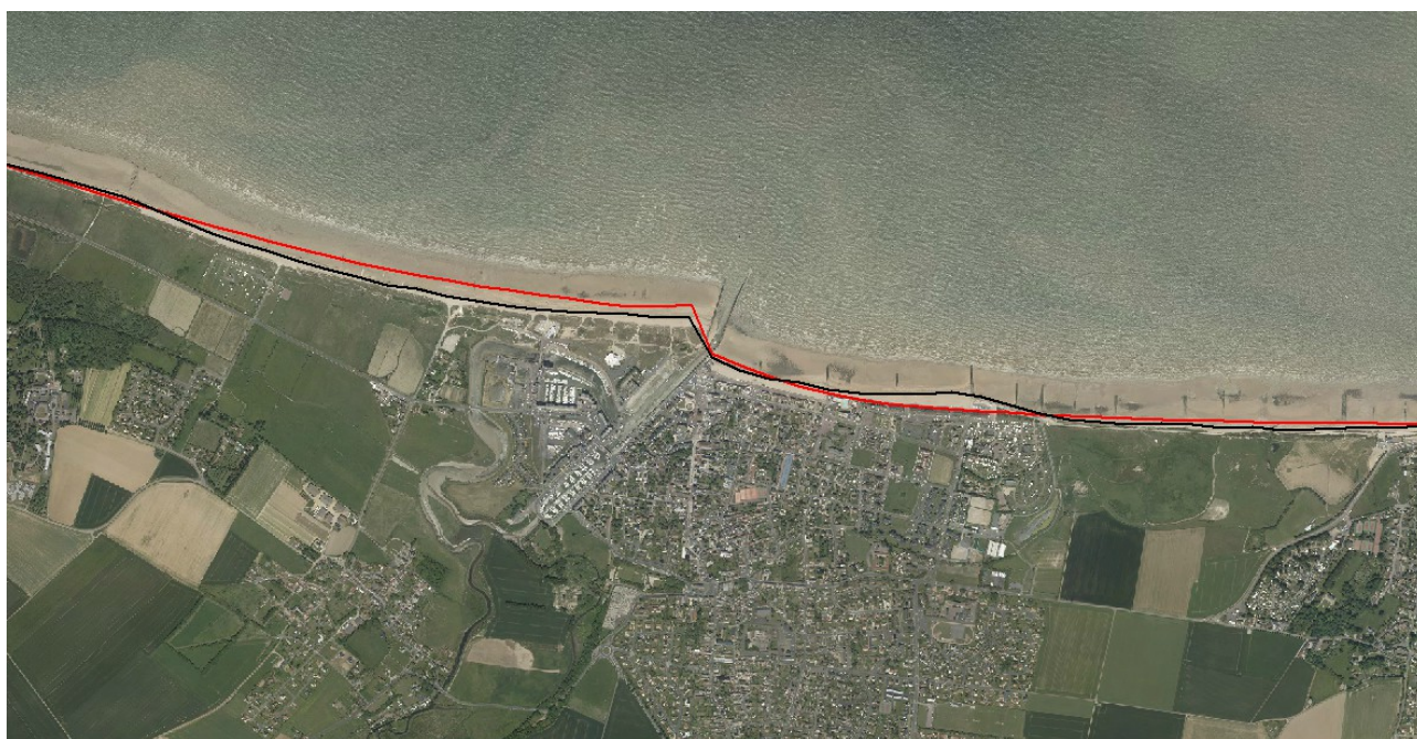
Figure IV.7: Comparaison du trait de côte actuel (noir) et à échéance 50 ans (rouge) au niveau du Port de Courseulles-sur-Mer : accrétion de la dune de Courseulles, érosion à l'Est du port.
