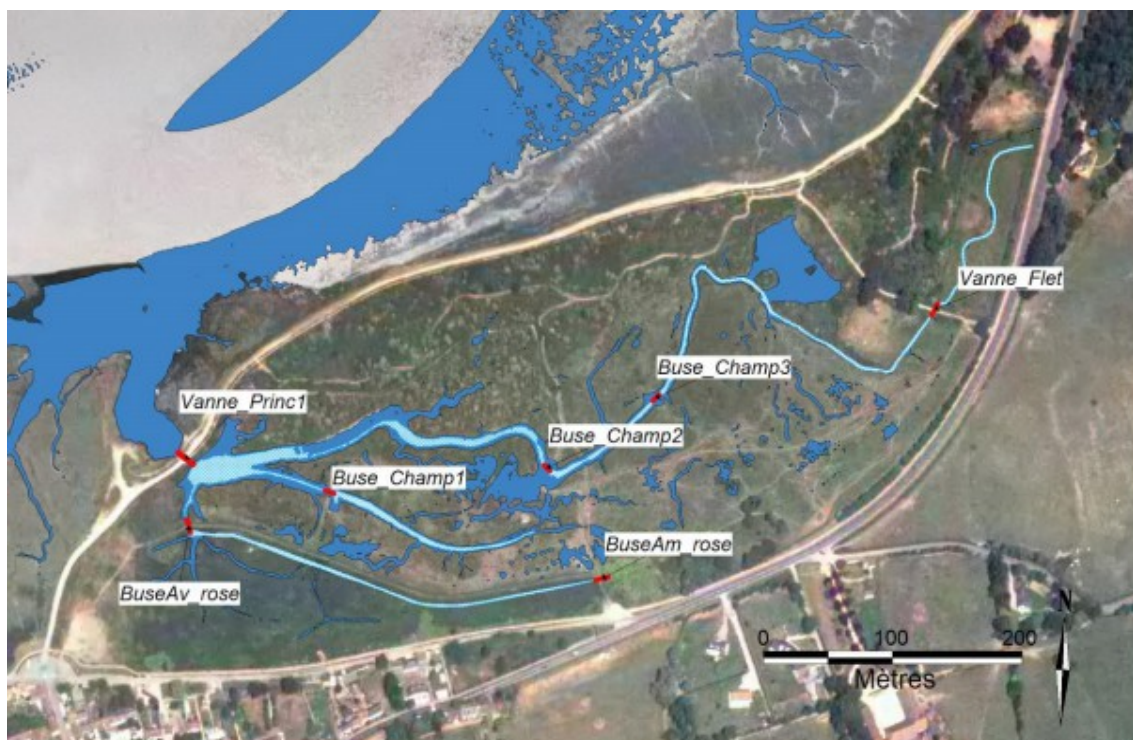
Figure 31. Représentation schématique du réseau et des ouvrages hydrauliques présents sur le site de projet (orthophoto 2000).
