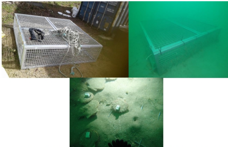
Figure 3 : Cage à Coquilles Saint-Jacques (en haut) et CSJ équipées d'accéléromètres (en bas)
