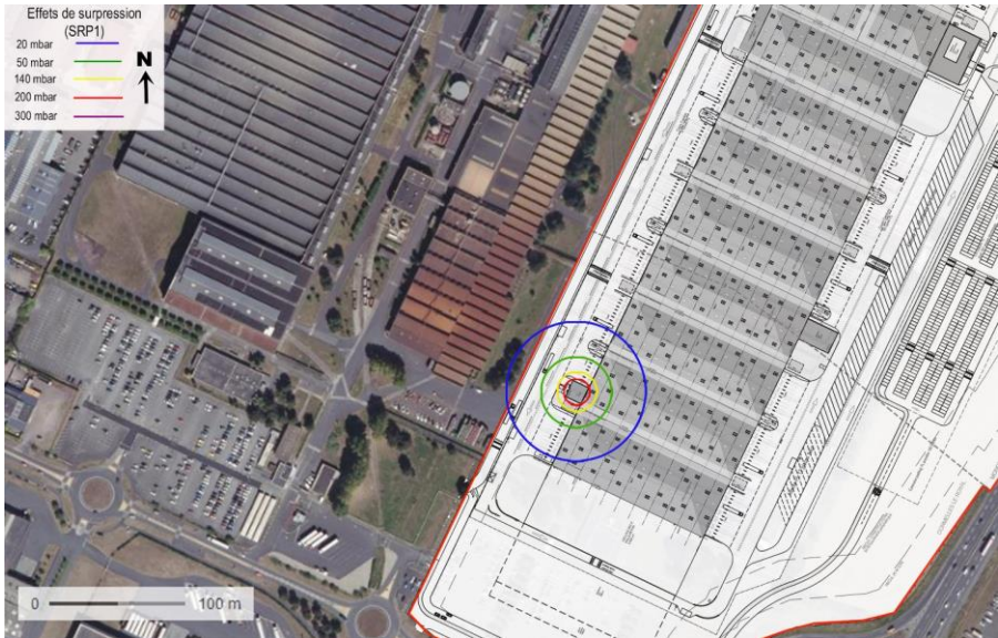
Effets de surpression générés par l'explosion du local chaufferie (SRP1)
