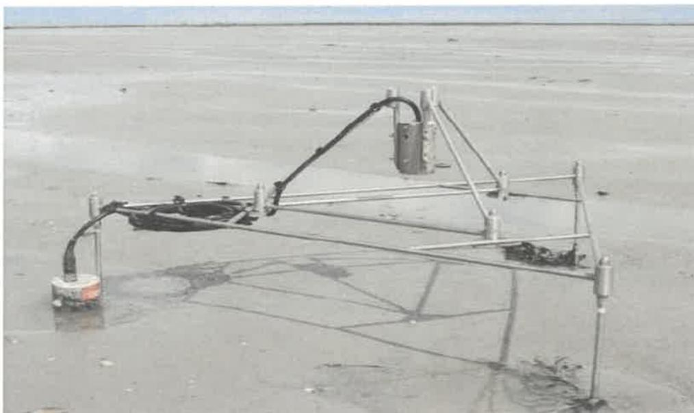
**Figure 4 : Altimètre haute fréquence implanté sur un estran**
