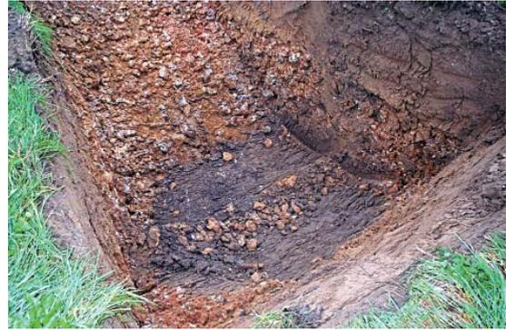
■ Fig. 61 - Exemple d'une cloche de fontis comblée découverte en sondage à la pelle.
