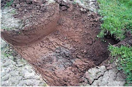
■ Fig. 60 - Exemple de béttoire découverte en sondage à la pelle.
