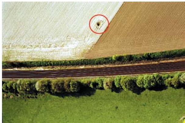
■ Fig. 49 - Exemple d'indice de cavité souterraine repéré en photographie aérienne oblique prise d'un ULM : cet effondrement de terrain est dû à la présence d'une cavité souterraine ; on peut observer les traces de l'engin agricole qui contournent l'effondrement.
