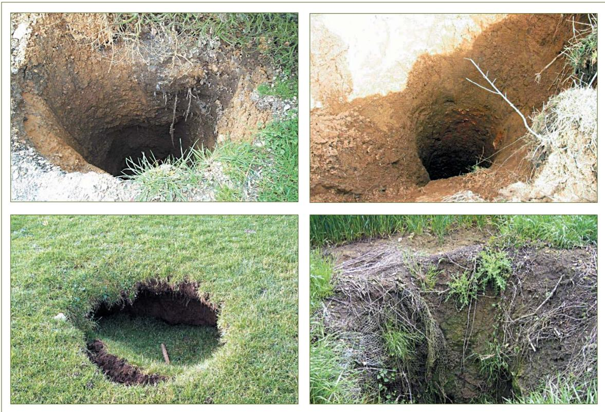
■ Fig. 36 - Effondrements dus à la vidange des matériaux de remblai d'un puits de marnière.
