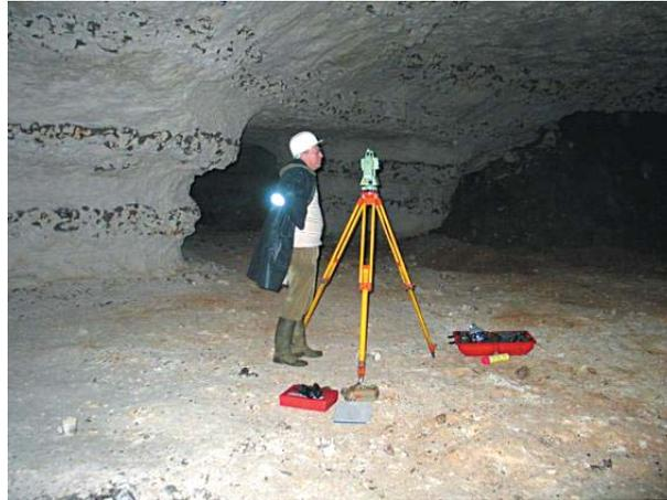
■ Fig. 73 - Levé d'une carrière souterraine par un géomètre.
