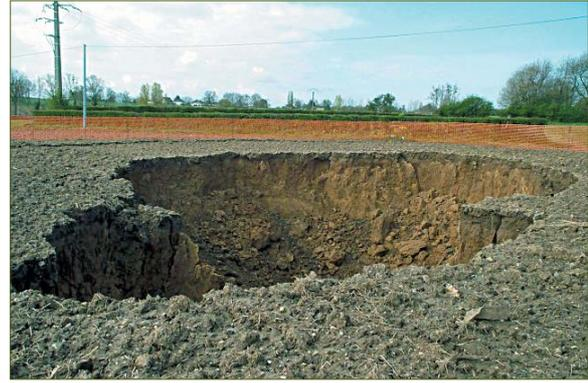
■ Fig. 40 - Effondrement (diamètre 15 m, profondeur 8 m) dû à la rupture partielle du toit d'une marnière.
