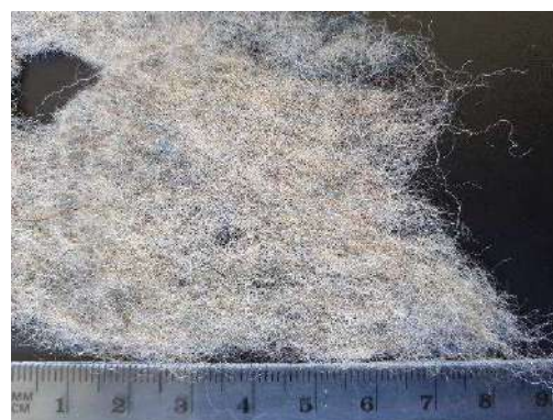
Figure 65 : Détail de l'échantillon de géotextile présent en arrière des enrochements au droit des parcelles 1030, 0779, 1050, 1049, 1000 et 0999 (n°80 à 96)
