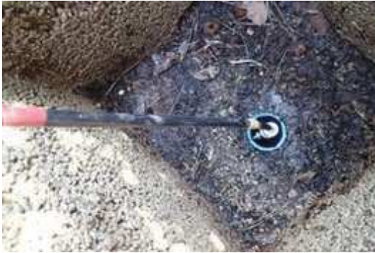
Figure 1 : Mesure inclinométrique dans le tube I1 (terrain de tennis).
