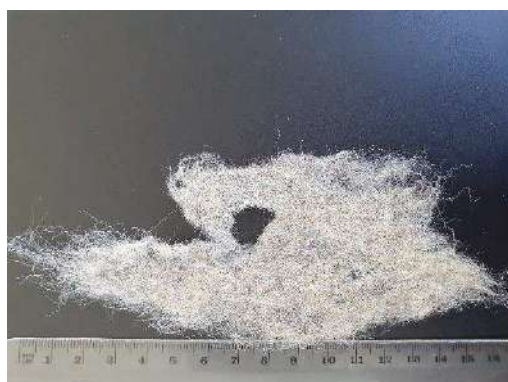
Figure 64 : Échantillon de géotextile présent en arrière des enrochements au droit des parcelles 1030, 0779, 1050, 1049, 1000 et 0999 (n°80 à 96)
