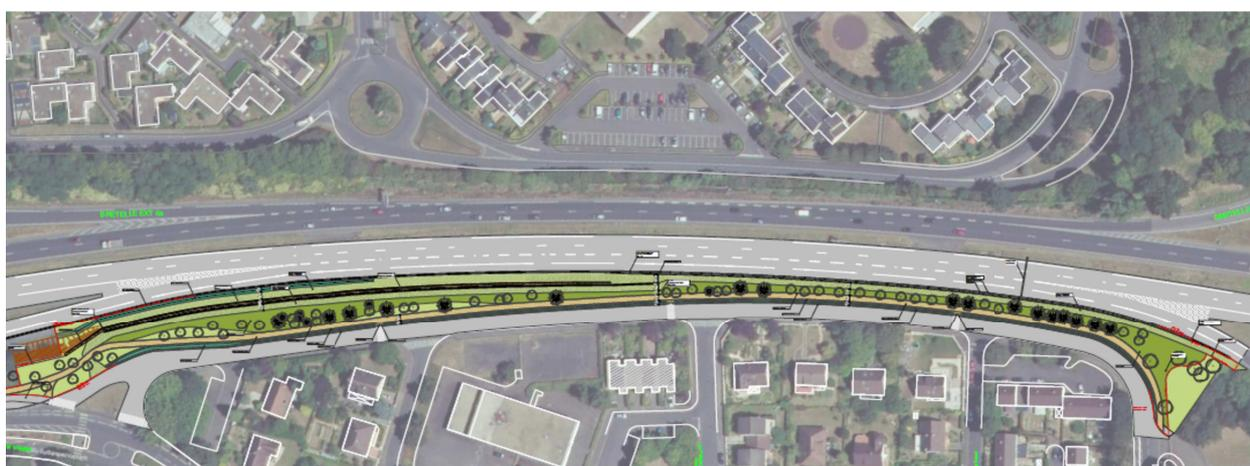
Figure 17: Plan de masse du projet de mur anti-bruit sur la partie Sud-Est du BP (RN814)
