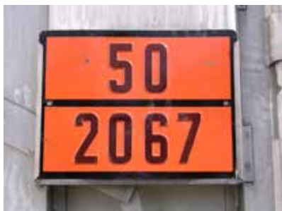
Signalisation orange d'un véhicule transportant en vrac des engrais au nitrate d'ammonium
