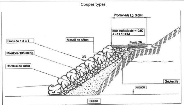
Figure 3 : coupe schématique de la digue de Villerville, sur le secteur est, reprise en 1998
